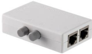
**Der Netzwerk-Switch ist optional und wird nur benötigt, wenn die DCU nicht an das Gebäude-LAN angeschlossen werden soll.**
