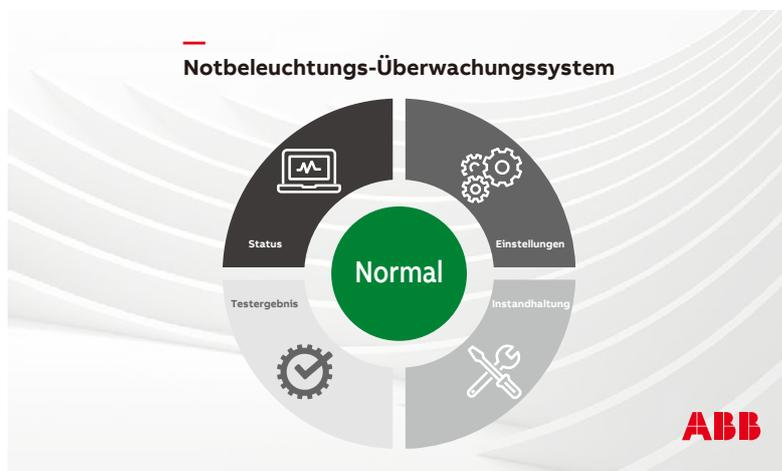
Das ist der Startbildschirm, der angezeigt wird, sobald das Gerät eingeschaltet wird. Während der Anzeige scannt die Anwendungssteuerung die beiden DALI-Leitungen und ermittelt, was angeschlossen ist.
