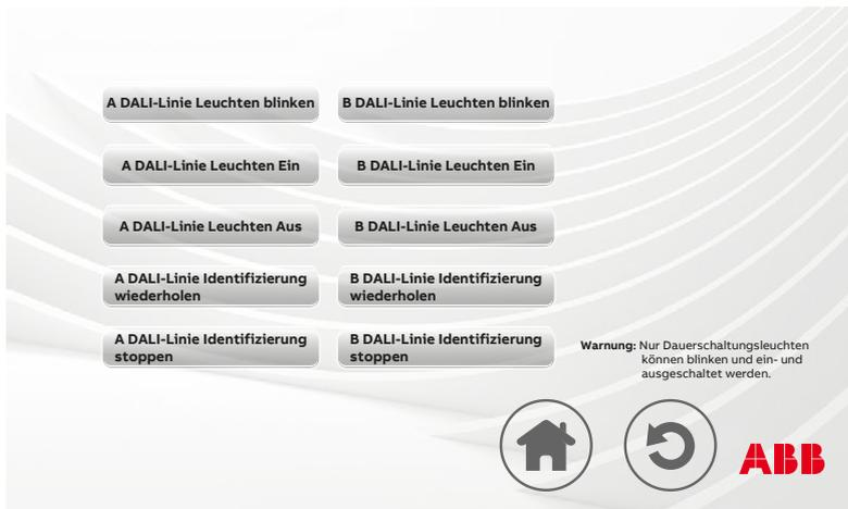
Diese Ebene enthält Funktionen, um den Techniker bei der Inbetriebnahme zu unterstützen.
