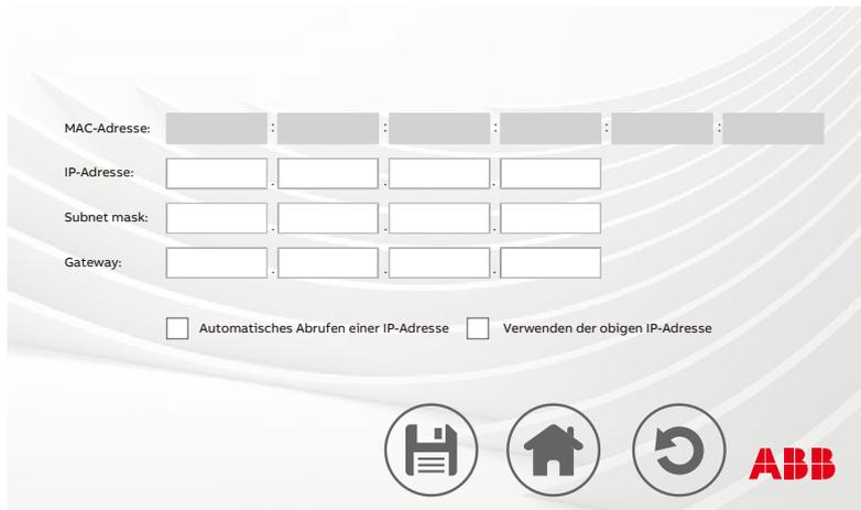
Die Netzwerk-Konfigurationsebene ermöglicht die Einstellung beliebiger spezieller LAN-Eigenschaften, die benötigt werden könnten. Alle weiteren Informationen zur LAN Konfiguration und der PC Software finden Sie weiter vorne.
