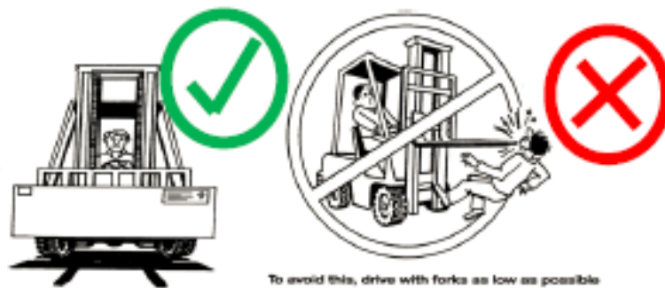
Fig. 6 Desplazamiento con horquillas bajas
