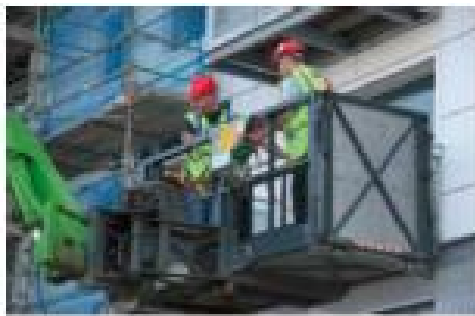
Fig. 8 ROLT equipada con una plataforma de trabajo integrada
