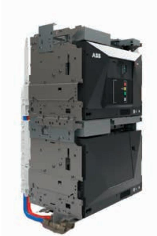
Der ABB Infinitus ist der erste halbleiterbasierte Leistungsschalter seiner Art für hohe Stromdichten, der Schaltfunktion, Isolierung und DC-Schutz für Nennströme bis 5 kA in einem einzigen Gerät integriert.
