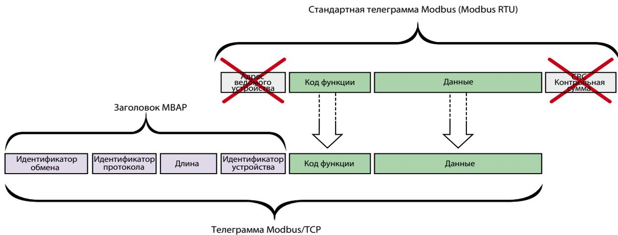
Рис. 36. Сеть Ethernet TCP/IP – Последовательный канал связи Modbus
