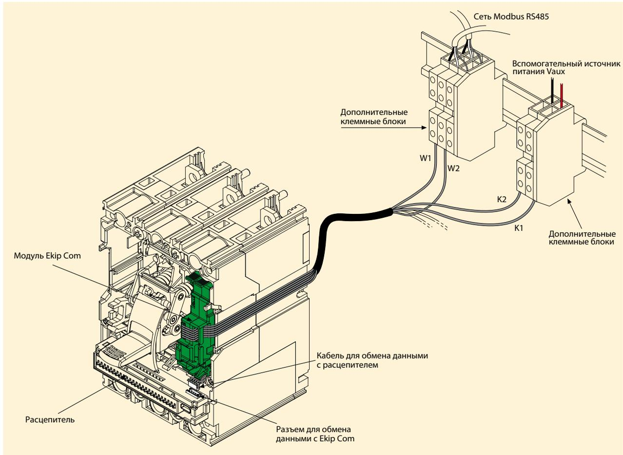
Для автоматических выключателей Tmax XT2-XT4 во втычном исполнении подключение электронных расцепителей с функциями обмена данными к сети Modbus происходит через 6-штырьковый разъем (XC5) по следующей схеме:
