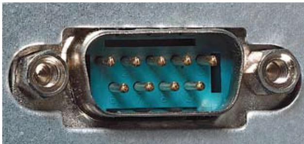
Рис. 10. 9-контактный последовательный кабель RS-232
