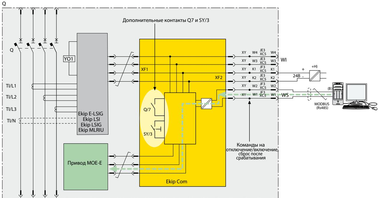
YO1: отключающий электромагнит расцепителя сверхтоков на базе микропроцессора
