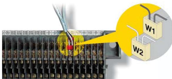
Если же зажим рассчитан на подключение только одного провода, следует создать отвод через дополнительные трехполюсные блоки контактов для каждого подключаемого выключателя, как показано на рисунке 27.
