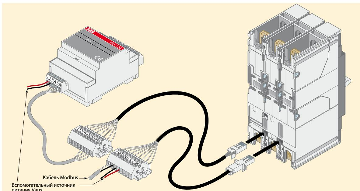
Рис. D.4. Подключение модуля VM210 к расцепителю PR223DS
