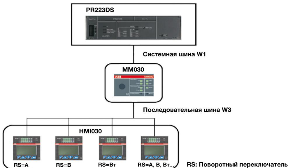
W1: системная шина расцепителя, поддерживающая обмен данными с локальной шиной W2 блока MM030 (контакты 10 и 11)
