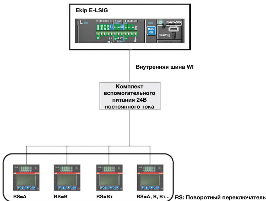
WI: внутренняя шина расцепителя (интерфейс CAN предназначен для устройств АББ; кабели W3 и W4 комплекта вспомогательного питания 24 В постоянного тока)
