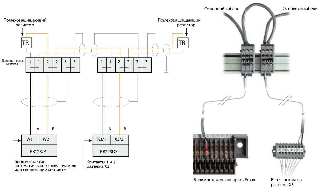
Чтобы избежать ошибок при подключении нескольких устройств, рекомендуется использовать один и тот же цвет для всех проводов, подключаемых, соответственно к контактам А и В данных устройств (например, белый для А и синий для В); это упростит поиск неправильных подключений.
