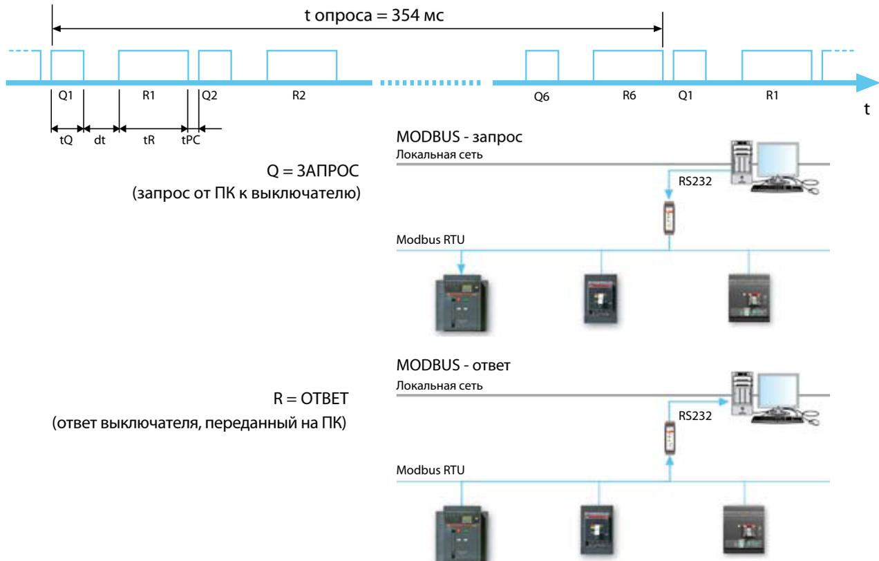
Исходя из этого, следует, что время опроса одного выключателя составляет примерно 59 мс. Считая его одинаковым для всех аппаратов, можно рассчитать примерный период опроса всех выключателей, который составит  $59 \times 6 = 354$  мс.
