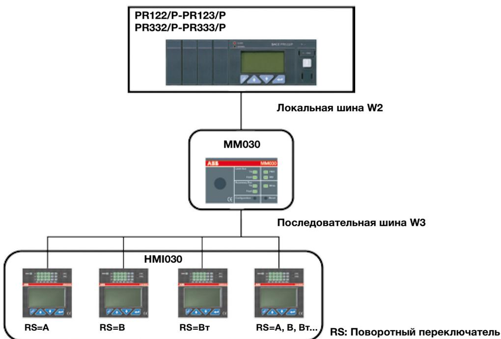
W2: Локальная шина расцепителя (клеммы W3 и W4) и блока MM030 (клеммы 10 и 11)
