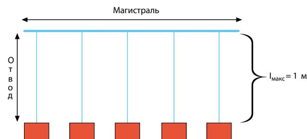
На рис. 24 показаны примеры неправильного подключения к шине.
