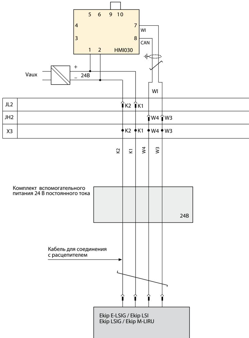
JL2-JH2: разъемы для комплекта вспомогательного питания 24 В постоянного тока для автоматических выключателей в выкатном исполнении
