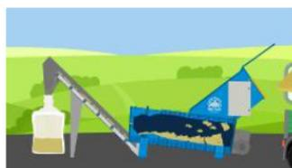
In einem Isolationsverdichter wird die zu entsorgende Mineralwolle zu einem feinen Pulver komprimiert.
