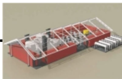
3 Skiss över Windformersystem. Likström från en vindpark leds i kabel till ett ställverk för nätet med en omriktare, som är kopplad direkt på nätet.
