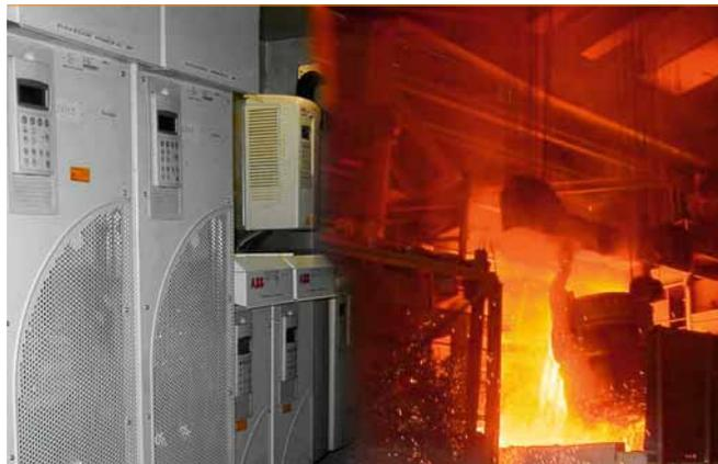
den Antrieb über das Internet ermöglicht. Der größte Vorteil für die Wartungsabteilung liegt jedoch in der Reduzierung der Gesamtwartungskosten aufgrund des geringeren mechanischen Verschleißes von drehzahlregulierten Antriebslösungen. Werden Krane mit elektrischen Antrieben ausgestattet, sinkt der mechanische Verschleiß aufgrund ihrer Sanftanlasserfunktion<sup>3)</sup> deutlich.
