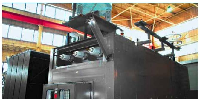
10 Ultraleiser ConEd-Transformator mit schallschluckenden Verkleidungen
