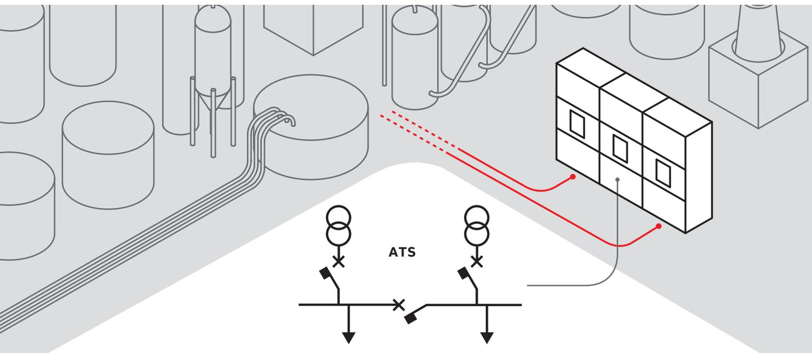
Das integrierte ATS-System erleichtert die Überwachung, Steuerung und Kommunikation in Stromnetzen.
