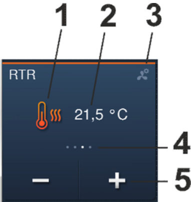
Abb. 8: Übersicht der Bedien- und Anzeigeelemente des Raumtemperaturreglers
