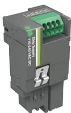
Le module Ekip Supply permet à tous les modules et déclencheurs Ekip présents sur le bornier et sur le disjoncteur d'être alimentés via des puissances auxiliaires AC ou DC disponibles dans l'appareillage. Selon la tension primaire utilisée, deux versions sont disponibles (110-240V AC/DC et 24-48V DC).
