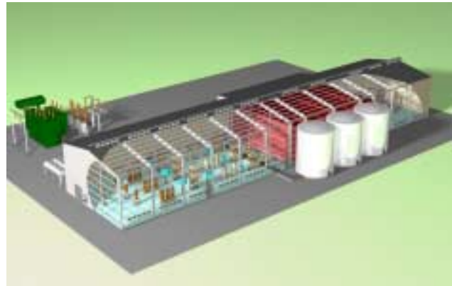
Bild 6 Anordnung einer Onshore-Stromrichterstation HVDC Light für 330 MW mit den Abmessungen L \times B \times H = 70 \times 30 \times 10 m
