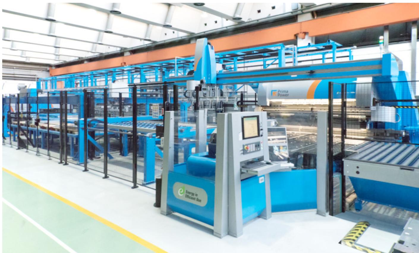
Integrazione di tutte le fasi della lavorazione con performance uniche. Il Magazzino verticale, che connette punzonatrice e pannellatrice, dà la possibilità di stoccaggio sia della materia prima che del prodotto semilavorato.
