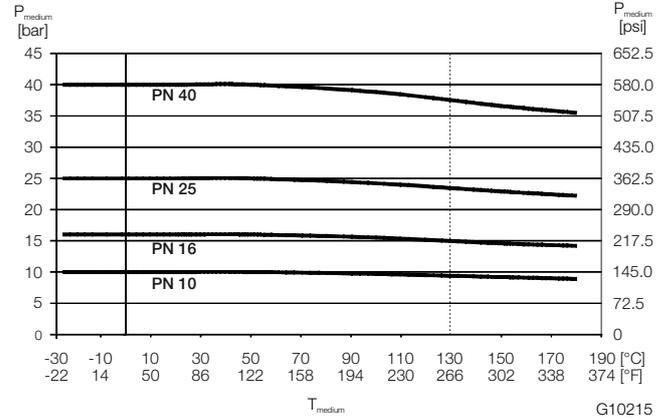
Рис. 4. Фланец DIN, нержавеющая сталь, до DN 100 (4")
