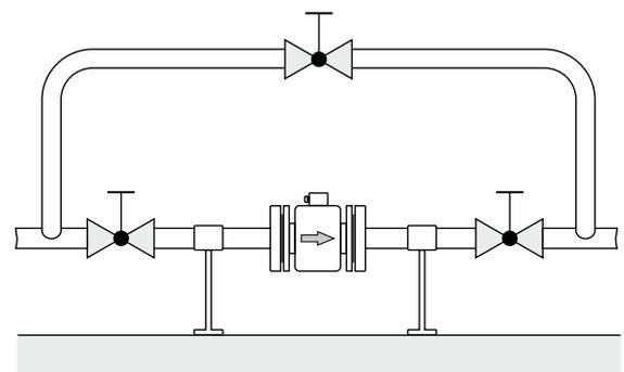
Рис. 14. Обходной трубопровод
