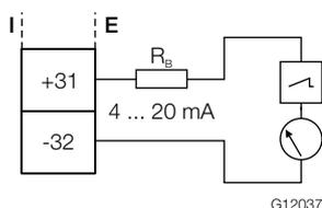
Рис. 28. Пример подключения активного токового выхода 31 / 32 (I = внутренний, E = внешний, R<sub>B</sub> = нагрузка)
