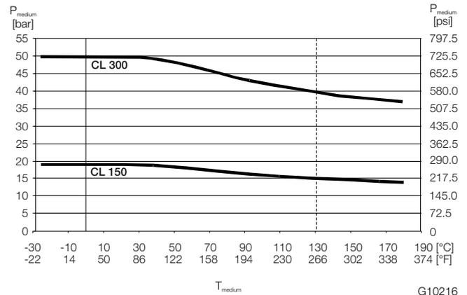
Рис. 5. Фланец ASME, нержавеющая сталь, до DN 100 (4")
