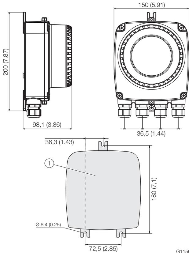
Рис. 26. Монтажные размеры (разнесенная конструкция)
