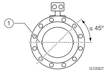
Рис. 9. Выверка оси расположения электродов
