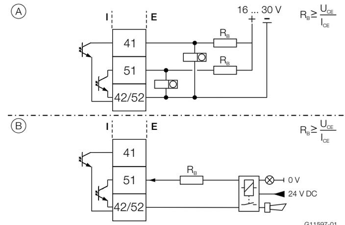
Рис. 29. Пример подключения (I = внутренний, E = внешний, R<sub>B</sub> = нагрузка)
