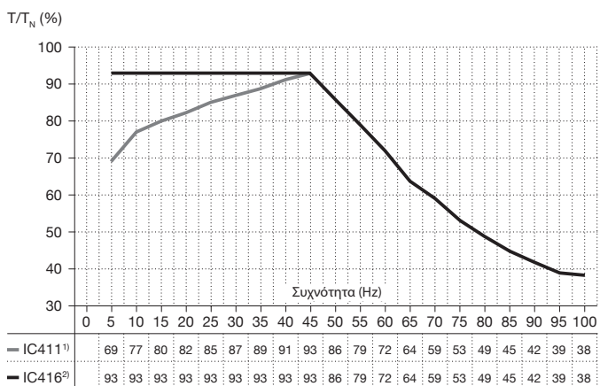
Σχήμα 9. Πυρίμαχοι ηλεκτροκινητήρες Ex d / Ex de T4, ηλεκτροκινητήρες από χυτοσίδηρο με προστασία από ανάφλεξη σκόνης Ex tD T150 °C, ονομαστική συχνότητα ηλεκτροκινητήρα 50/60 Hz
