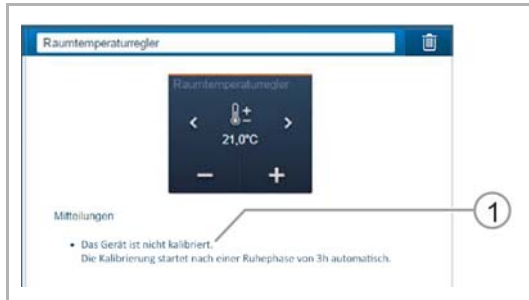
Abb. 17: Kalibriervorgang bei Erstinbetriebnahme
