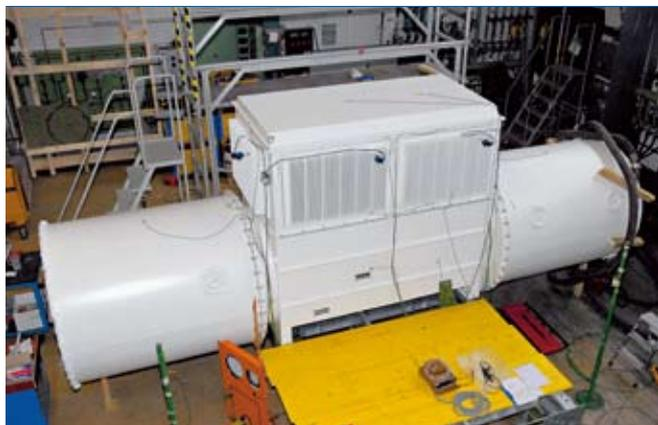
❷ 与腔室连接的蒸发器和绝缘体。水气从波形绝缘管流入冷凝器 (参见❸)
