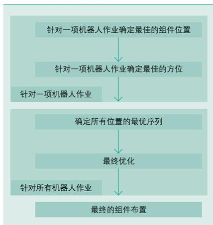
5 Machine Tending PowerPac生成的优化的机器取放件单元
