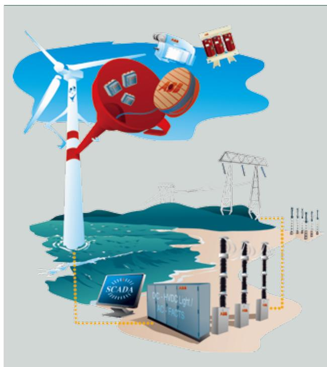
地区发电场所生产的电力必须经过高效的远距离传输给陆上用户——通常是远离海岸的内陆地区。ABB 为该种电力传输同时提供交流电缆和直流电缆。由开关设备、中压开关、变压器和控制设备构成的电能控制平台上与风机相连，经过控制平台后，电压等级被进一步升高。然后，电力在陆地上通过三相交流电缆传输或者进一步转换为直流电后通过 HVDC Light<sup>®</sup> 传输系统传输<sup>1)</sup>。
