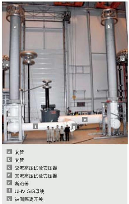
4 巴登大功率实验室 (瑞士) 开发团队和用于 1,100 kV 断路器的试验电极在 T100s 试验后的合影
