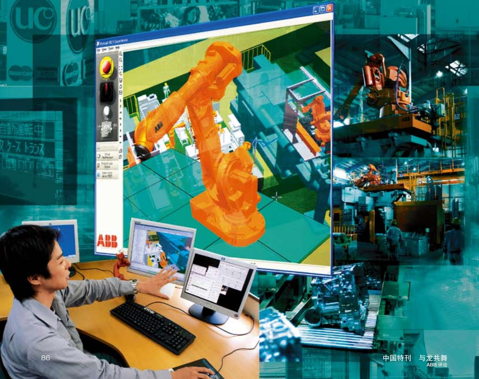
**传**统的机器人仿真和离线编程工具一般都针对拥有专业知识的工程师而设计，而没有考虑那些仅有有限工程背景的销售人员的需要。在销售人员看来，现有的仿真和离线编程工具难以使用，因为他们要求使用者掌握一系列专业知识和能力，包括：几何建模知识、生成和调整机器人目标和路径的能力、路径构建、单元对象定位等。
