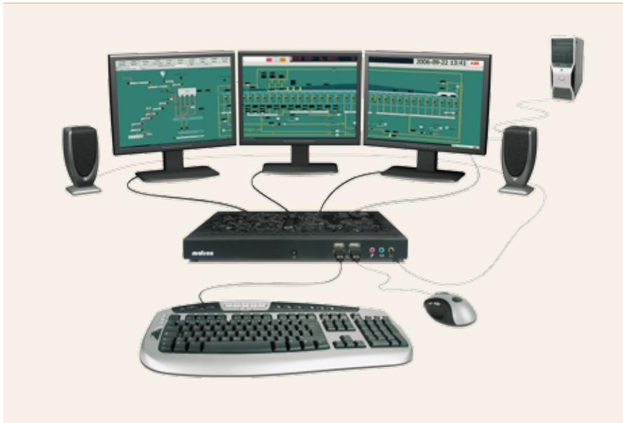
显示屏直接安装在工作台桌子的后面，而没有装设在墙壁上，这样的设置是考虑到当有人通过时不会影响到操作人员监控纵览图。另外一个工作环境的改善是可以选择性地计算机主机设备全部撤出控制室，以应对普遍发生的问题：发热量高、噪音大、空间有限和安全性问题。
