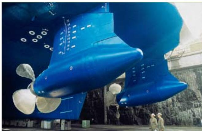
通过变频传动向 Azipod 单元供电，实现对传动器电机的速度控制。
