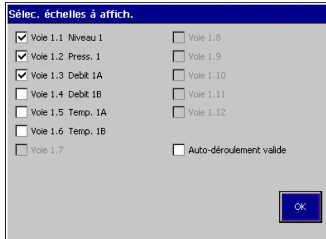
Sélectionnez la/les échelle(s) à afficher dans la barre d'échelle située en haut de la fenêtre du diagramme. Pour les voies numériques, les indicateurs Marche et Arrêt s'affichent à la position correspondante sur la barre d'échelle. Trois échelles au maximum peuvent s'afficher simultanément.
