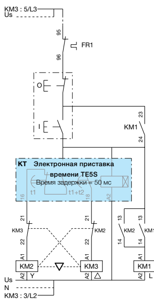
Схема цепи управления: дистанционный режим
