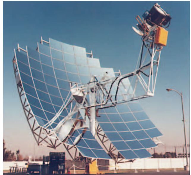
Abbildung B.6 - Anlage mit Parabolspiegel-Konzentrator
