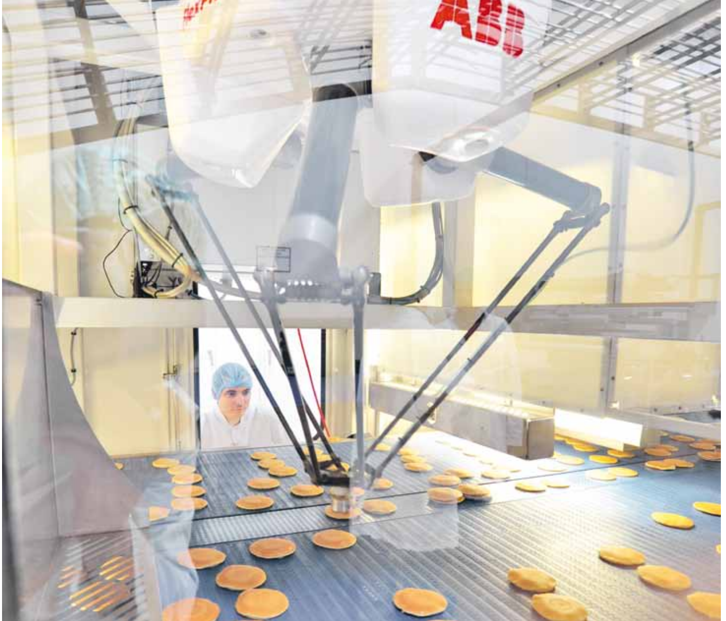
Die Software PickMaster 3 führt die FlexPicker IRB 360 zum Aufnehmen und Positionieren der Pancakes, auch wenn diese übereinanderliegen.
