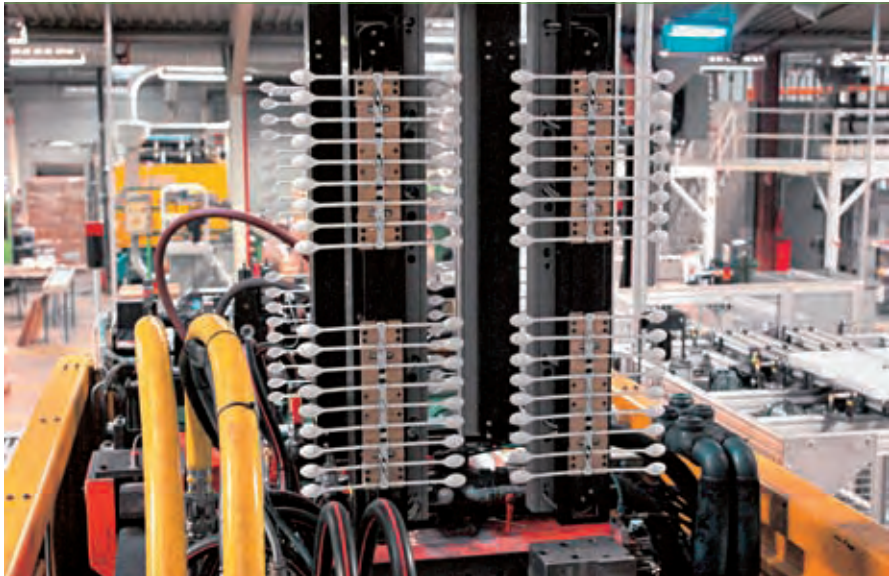
在比利时的 deSter，IRB 6650 机器人正从注塑机上取出汤匙
