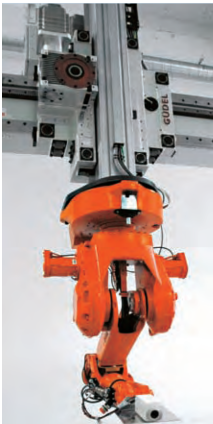
6 安装在联动龙门机架上的ABB视觉检测机器人
