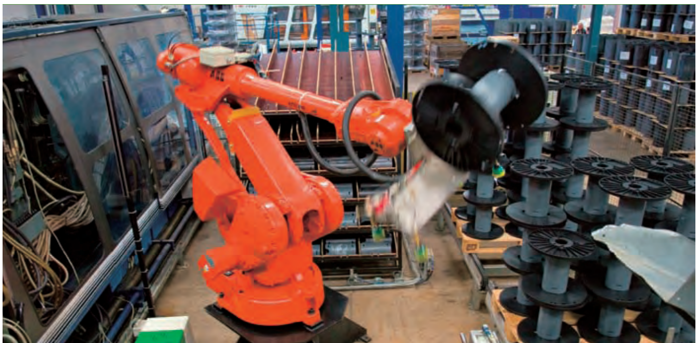
■ 在瑞典的 Axjo 工厂，IRB 4400 正从注塑机上提取零件，并装配塑料卷盘。（照片由 Alexander Farnsworth 提供）
