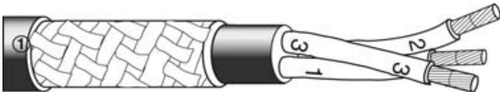
Verzinkter Stahl oder verzinnte Kupferleiter mit geflochtenem Schirm
