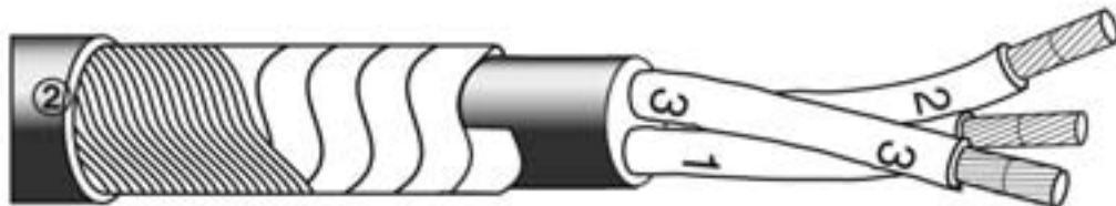
Lage Kupferband mit konzentrischer Lage Kupferdraht
