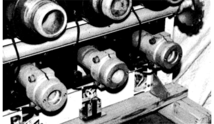
Fig. 4-6. Phase Sensor Wiring Installation
