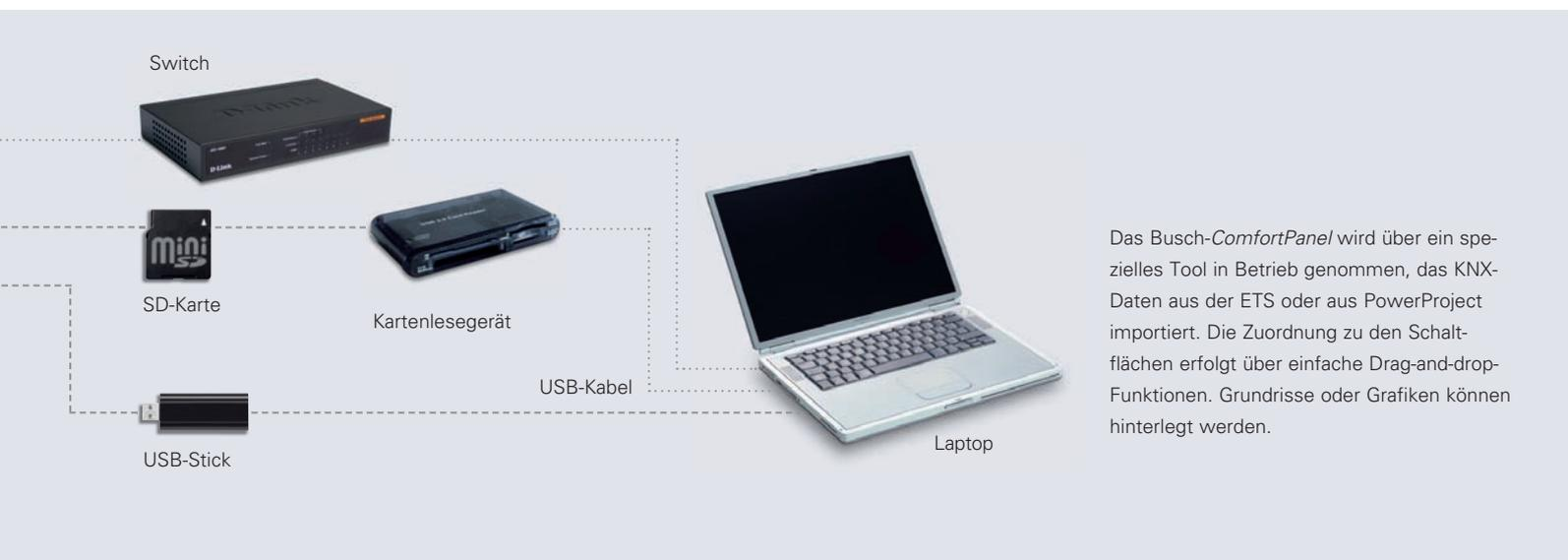
Das Busch-ComfortPanel wird über ein spezielles Tool in Betrieb genommen, das KNX-Daten aus der ETS oder aus PowerProject importiert. Die Zuordnung zu den Schaltflächen erfolgt über einfache Drag-and-drop-Funktionen. Grundrisse oder Grafiken können hinterlegt werden.
