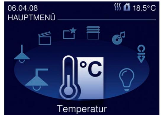
Busch-priOn wurde zur Steuerung eines Raums ausgelegt und ermöglicht ganz unterschiedliche Funktionen von der Temperaturregelung bis hin zum Wecker. Besonders anwenderfreundlich: Das Display wird erst durch Knopfdruck eingeschaltet – ist es inaktiv, funktioniert Busch-priOn wie ein ganz normaler Schalter und löst auf Knopfdruck eine zuvor festgelegte Primärfunktion aus. Das macht die Bedienung auch für Gäste ganz einfach.
