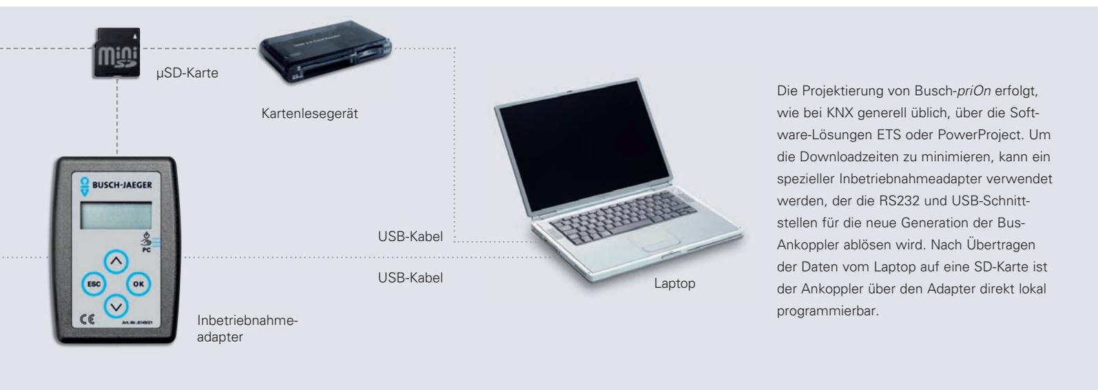
Die Projektierung von Busch-priOn erfolgt, wie bei KNX generell üblich, über die Software-Lösungen ETS oder PowerProject. Um die Downloadzeiten zu minimieren, kann ein spezieller Inbetriebnahmeadapter verwendet werden, der die RS232 und USB-Schnittstellen für die neue Generation der Bus-Ankoppler ablösen wird. Nach Übertragen der Daten vom Laptop auf eine SD-Karte ist der Ankoppler über den Adapter direkt lokal programmierbar.
