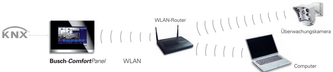
Das Busch-ComfortPanel ist in der Lage, WLAN-basierte Anwendungen anzuzeigen und zu regeln. Überwachungskameras bieten eine schnelle visuelle Information über Vorgänge in ihrem Erfassungsbereich. Sie können einzeln angesteuert und das erfasste Bild kann auf dem Panel dargestellt werden. Als Voraussetzung müssen die Überwachungskameras IP-fähig sein. Vorteilhaft ist ebenso der drahtlose Anschluss eines Computers am Busch-ComfortPanel.
