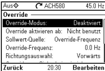
Wählen Sie unter **Menü > Grundeinstellungen > Override > Override-Modus** Normal oder Kritisch aus. Normal folgt der programmierten Anzahl der Störungsquittierungen im Override-Modus. Kritisch ermöglicht eine unbegrenzte Anzahl von Störungsquittierungen. Deaktiviert zeigt an, dass Override nicht verwendet wird.
