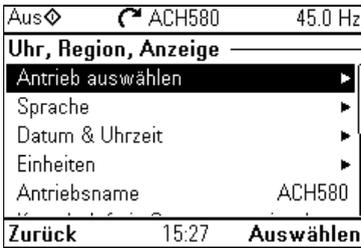
Das Untermenü **Uhr, Region, Anzeige** enthält die Einstellungen für die Auswahl von Sprache, Datum und Uhrzeit, Display-Einstellungen (z. B. Helligkeit) und Einstellung für die Anzeige von Informationen auf dem Display.
