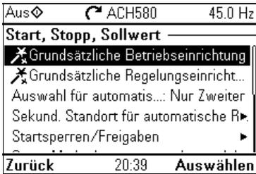
Mit dem Untermenü **Start, Stopp, Sollwert** werden die Start/Stopp-Befehle, der Sollwert und verwandte Merkmale, wie Konstantdrehzahlen oder Erlaubnisse für den Betrieb eingestellt.
