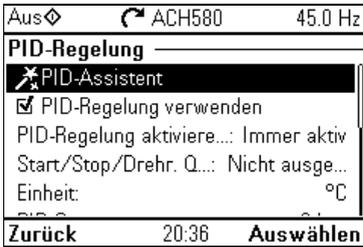
Das Untermenü **PID-Steuerung** enthält Einstellungen und Istwerte für die Prozessregelung. Die PID-Regelung kommt nur bei Fernsteuerung zum Einsatz.
