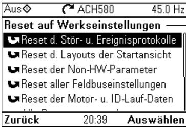
Das Untermenü **Auf Werkseinstellung zurücksetzen** ermöglicht das Zurücksetzen von Parametern und anderen Einstellungen.
