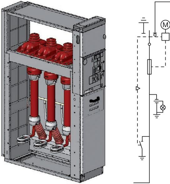
Ячейки типа SFS используются тогда, когда необходим секционный выключатель с защитными предохранителями. Для заземления предохранителей встроенный заземлитель действует на стороне питания, в то время как отдельный заземлитель действует на стороне нагрузки предохранителей.
