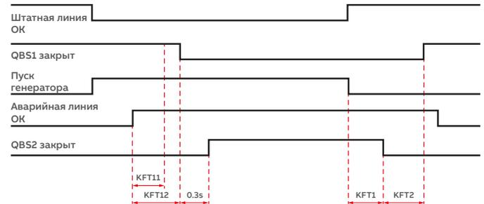
**KFT11** = задержка при отсутствии генератора для защиты от падения напряжения [0,1 с ÷ 16,5 ч]
