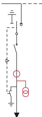
SBC: ячейка ввода/вывода с силовым выключателем и выключателем нагрузки
