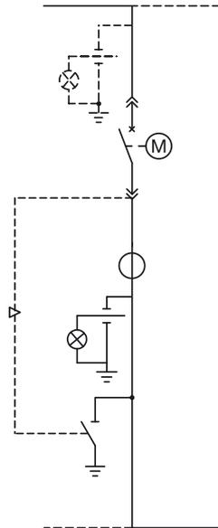
Ячейка имеет ширину 600 мм (12–17,5 кВ) и 750 мм (24 кВ). Ячейка WBS для изоляции с выкатным выключателем используется вместе с ячейкой подъема DRS 2000. Ячейка имеет классификацию LSC2B-PM для ячеек до 17,5 кВ и LSC2B-PI на 24 кВ и состоит из трех отсеков для шин, изолирующих шин и аппарата, отделенных друг от друга металлическими шторками (до 17,5 кВ) или изолирующими шторками (на 24 кВ).
