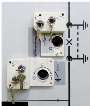
Позволяют каждой из управляющих блокировок выключателя (линия или заземление) оставаться заблокированной в выключенном или включенном положении. Одновременно можно использовать максимум два ключа для одной линии и два ключа для заземления. Имеются три типа ключей: стандартный, Ronis и Profilux. Блокировку линии выключателей нагрузки с приводом с двойной пружиной 2S нельзя заблокировать во включенном положении.
