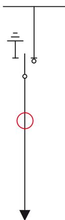
SDC: ячейка ввода/вывода линии с выключателем-разъединителем
