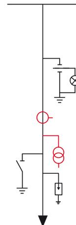
BME: ячейка прямого ввода со средствами измерения и заземлением сборных шин
