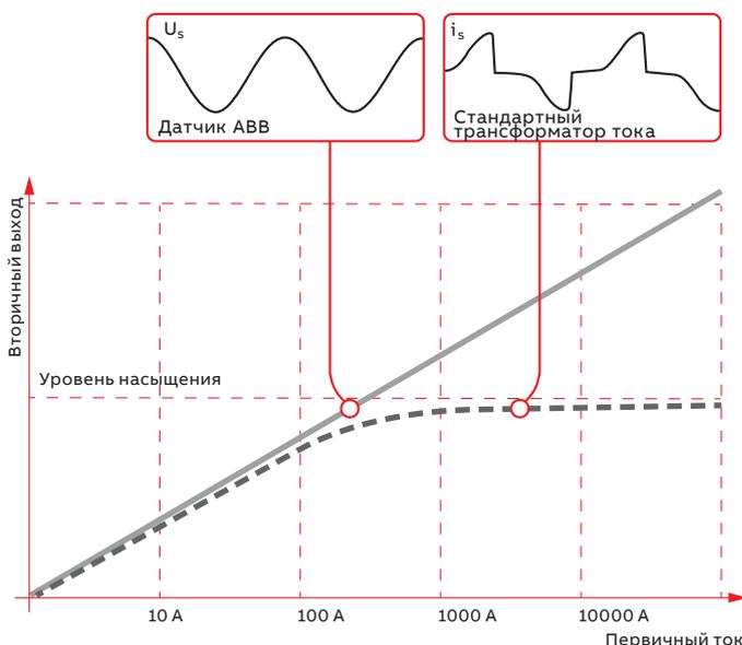
Линейность датчиков компании АББ и сравнение с формой волны выходных сигналов традиционного тока насыщения
