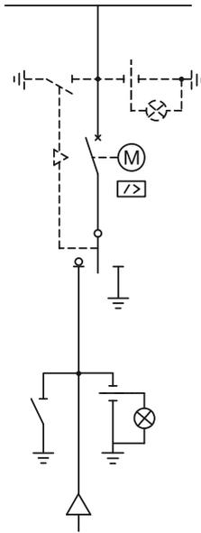
SBR позволяет выключать и заземлять выключатель нагрузки, оставляя в рабочем состоянии отсек кабелей. Стандартные ячейки оснащены 3-позиционным выключателем нагрузки, последовательно подключенным к силовому выключателю.
