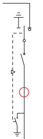
SBS: ячейка секционирования с силовым выключателем и выключателем нагрузки
