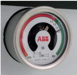
Манометр отображает давление газа и предоставляет аналоговую индикацию значения.
