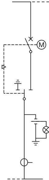
Ячейка HBS оборудуется многофункциональным аппаратом HuSec с встроенными вакуумным выключателем и выключателем нагрузки с 3 положениями (включен - изолирован - заземлен) с элегазовой изоляцией.
