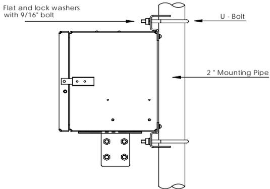
**Figs 2 (Montaje en tubo)**
