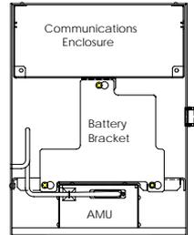
3. Conecte el conector del bloque de baterías al conector J1 d de la tarjeta electrónica principal del XFC o al conector J16 en el XRC, ubicado en la esquina superior derecha de la tarjeta.
