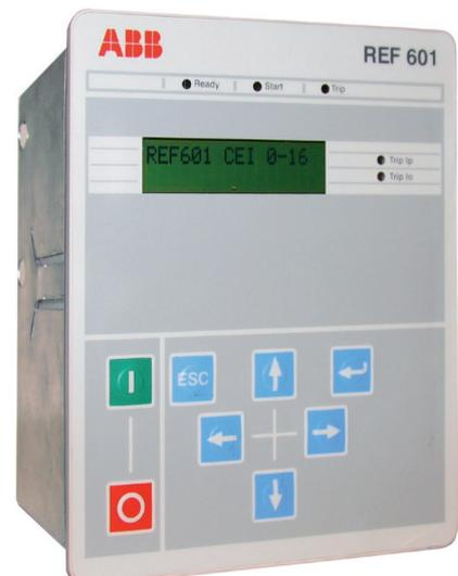
El dispositivo de protección REF 601 tiene los pulsadores para el mando eléctrico de apertura y de cierre del interruptor; el mando eléctrico de apertura resulta siempre operativo porque el interruptor HD4/R se suministra de serie con el relé de apertura -MBO1 (kit 2); para que también el mando eléctrico de cierre resulte operativo es necesario equipar el interruptor con el relé de cierre -MBC.
