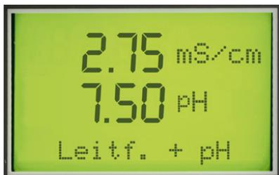
Gleichzeitige Leitfähigkeits- und pH-Messung
