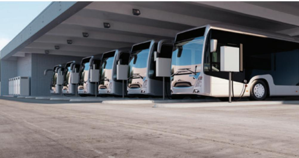
**Coffret déporté CCS2 simple prise :** charge séquentielle de 4 bus maximum (4 coffrets déportés sont nécessaires)
