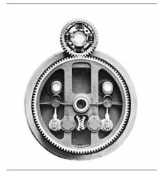
À l'intérieur de la roue dentée, un système de biellettes et d'engrenages permet la transmission du couple et le libre débattement de l'essieu moteur.
