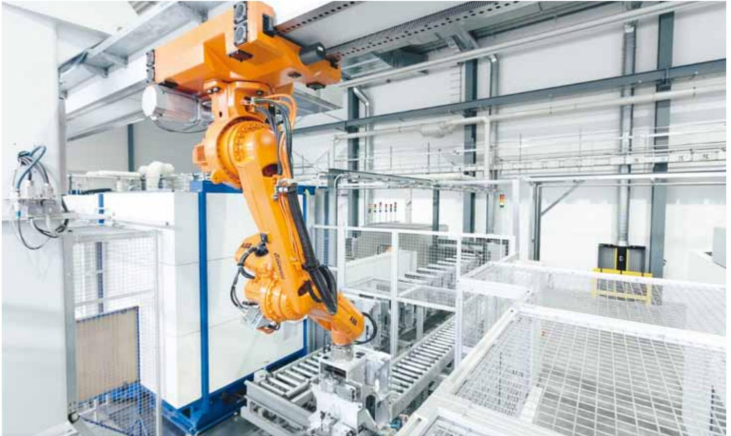
Der IRB 6620LX be- und entlädt die Bearbeitungszentren für Gehäuse.
