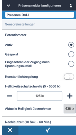
Şek. 41: Gün ışığına bağlı kumanda için aydınlık derecesi nominal değerinin ayarlanması
