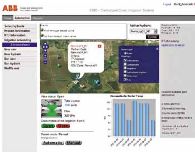
El sistema Neptuno se ha convertido en el CSIS que permite el acceso a la interfaz de SCADA mediante tecnologías de web normales aplicando el concepto SaaS. El cliente no necesita disponer ni mantener ninguna infraestructura específica.
