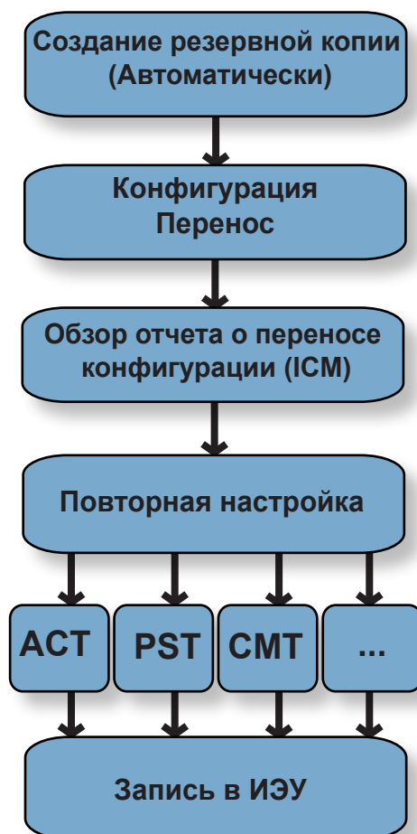
Рис. 93: Процедура преобразования конфигурации ИЭУ
