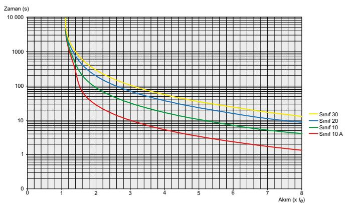
Dahili elektronik aşırı yük koruması için açma eğrileri PSE, dört farklı açma sınıfına ayarlanabilecek dahili bir elektronik aşırı yük korumasına sahiptir. Soğuk durumda her açma sınıfı için bir eğri gösterilmiştir..
