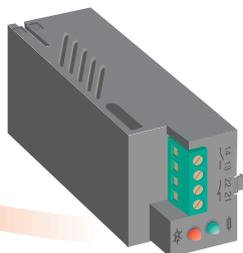
Монитор состояния предохранителей OFM обеспечивает возможность незамедлительного срабатывания и/или индикации перегоревшего предохранителя в целях предотвращения попадания двухфазной нагрузки на электродвигатель. Монитор можно использовать с предохранителями любых типов.
