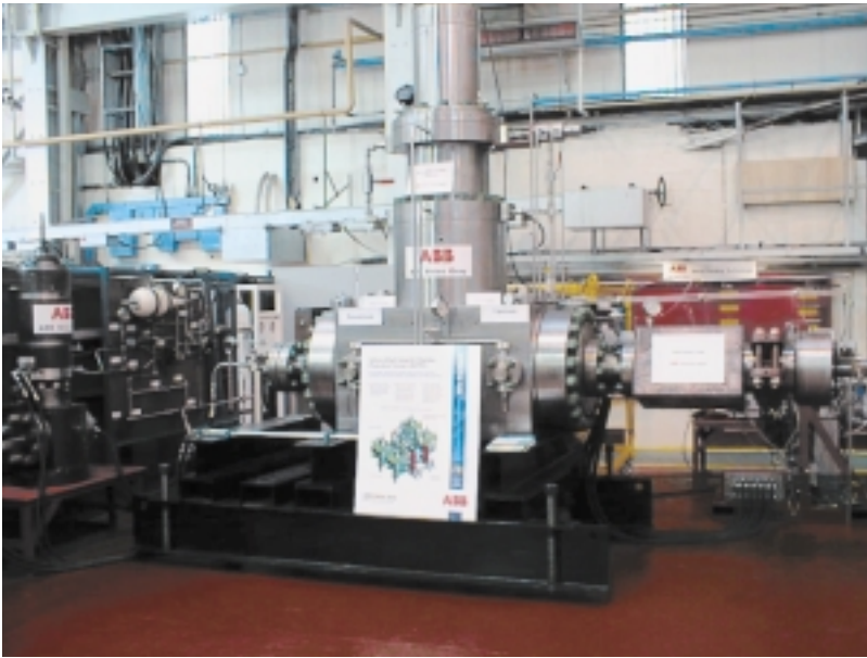
7 High Integrity Pipeline Protection System (HIPPS) während der Prüfung im Labor
