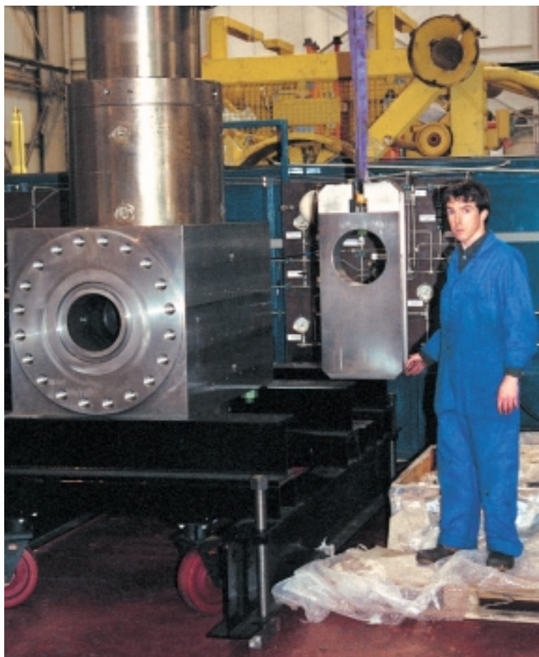
6 In ein Prototypventil (250 mm, 1035 bar) eingesteckter Absperrschieber
