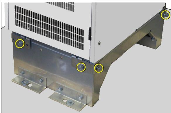
3. Fixer les supports de la plaque frontale à la plinthe avec des vis (hexagonales M8×20 à filetage intégral ou équivalent), des rondelles M8 et des écrous.
