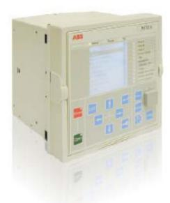
Cuando se usa protección REF de baja impedancia no se necesitan resistencias ni varistores de estabilización y como beneficio adicional la relación de transformación de los TC de neutro puesto a tierra puede diferir de aquella de los TC de fase. Debido a su caracter de protección unitaria y selectividad absoluta, la protección REF no necesita graduación de tiempo con otros esquemas de protección, y por lo tanto se puede conseguir despeje de falla de alta velocidad.
