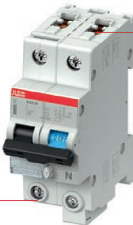
De nouvelles bornes doubles brevetées, équipées de vis captives, pour un maximum de confort, de sécurité et de flexibilité. Le raccordement se fait dans deux chambres (35 mm<sup>2</sup> et 10 mm<sup>2</sup>). Deux conducteurs de même section transversale peuvent être raccordés dans chacune d'elle.
