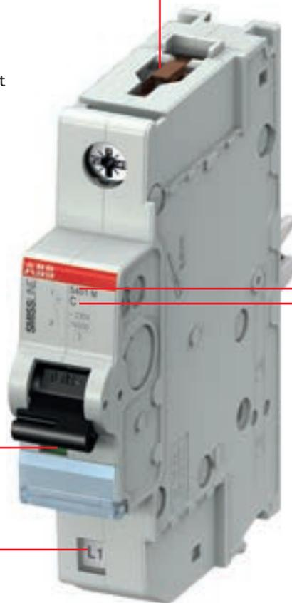
Caractéristiques de déclenchement B, C, D, K, UCC et UCZ. Capacité de coupure assignée comprise entre 6 kA et 10 kA selon la norme CEI/EN60898-1 (B, C, D) et entre 6 kA et 25 kA selon la norme CEI/EN60947-2 (C et K). Nouveau S400P High Performance MCB jusqu'à 40 kA.
