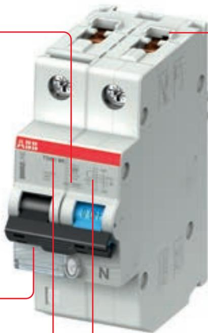
De nouvelles bornes doubles brevetées, équipées de vis captives, pour un maximum de confort, de sécurité et de flexibilité. Le raccordement se fait dans deux chambres (35 mm<sup>2</sup> et 10 mm<sup>2</sup>). Deux conducteurs de même section transversale peuvent être raccordés dans chacune d'elle.
