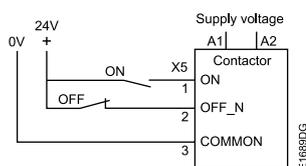
AFS116 ... AFS146 sono dotati di ingressi a bassa tensione per il controllo, ad esempio tramite PLC.
