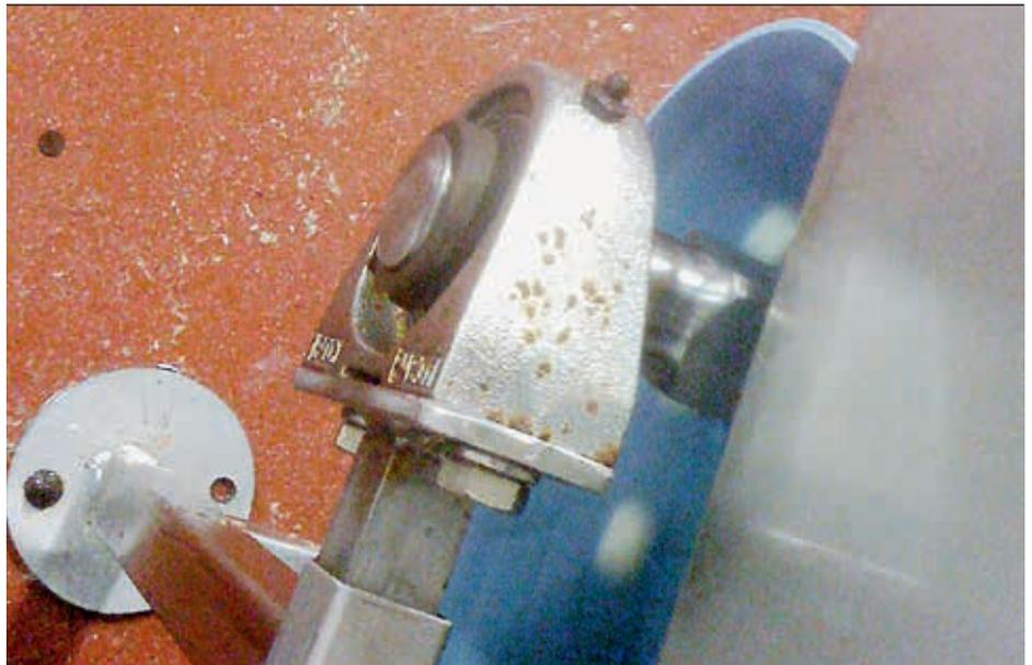
Stahl muss von ausreichender Güte sein, und das Gehäuse muss so gestaltet sein, dass Flüssigkeiten frei abfließen können. Außerdem müssen die Schweißnähte glatt sein, damit sich keine Bakterien festsetzen können.
