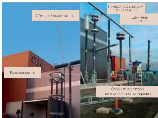
6 Испытание электрической прочности изоляции на стенде с испытательным напряжением 800 кВ на предприятии STRI, Людвика (Швеция)
