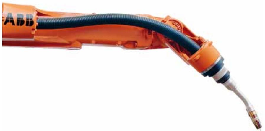
所有软管和电缆均采用妥善的紧固和保护措施，减少了在焊接飞溅物中的暴露面积，从而大大延长了使用寿命。购买和更换成本降低 75%，每年可减少三次停产。此外，Fronius、Esab、Binzel 和 SKS 等多家主要弧焊工艺设备供应商还为 IRB 2600ID 量身打造了完善的焊接包。
