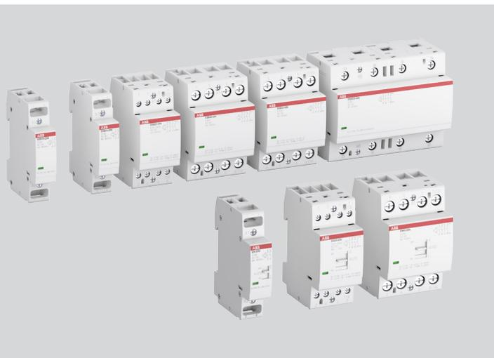
Ассортимент новых модульных контакторов АББ расширен до устройств с номинальными токами от 16 до 100 А. Новые контакторы ESB..N/EN..N разработаны для коммутации цепей освещения, управления системами отопления, электродвигателями и насосным оборудованием. За счет применения универсальной катушки питания (AC/DC), которая не издаёт шума и вибраций при эксплуатации, контакторы можно использовать в любых областях применения, где требуется соблюдение тишины и спокойствия людей.
