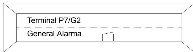
Todos los errores detectados (errores 0-9, A y B) se señalizan en los terminales. Si se produce alguna condición de error, los terminales P7, G2 (Ux, P7 en el caso de Profibus) se activan y, en este caso, se abren.
