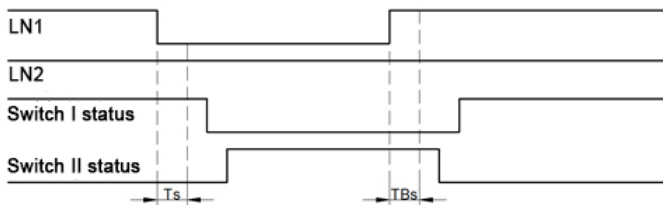
Рис. 2. Последовательности автоматического переключения блока OTM_C_21D, приоритет линии 1
