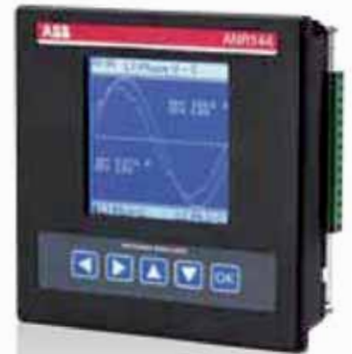
L'analizzatore di rete ANR permette l'analisi della qualità della rete grazie all'analisi delle componenti armoniche fino al 31° ordine e alla visualizzazione della forma d'onda.
