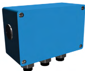
Kleiner Aluminium-Klemmenkasten für die Baugrößen 280 - 450 (Variantencodes 418, 568, 380, 569). Die Größe des anhand dieser Codes bestellten Klemmenkastens hängt von der Anzahl der bestellten Hilfseinrichtungen ab. 80 x 125 mm, max. 12 Klemmenleisten. Erdungsschraube M4
