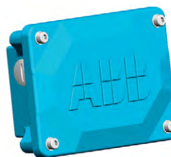
Hilfsklemmenkasten Grauguss Baugrößen 160 - 250 (Variantencode 418): 111 x 162 mm, max. 18 Klemmenleisten. Keine Erdung.
